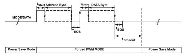
Figure 8-8. MODE/DATA Pin: Power-Save-Mode and Interface Communication
