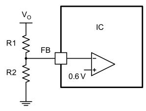
Figure 24. Voltage-Divider Circuit
