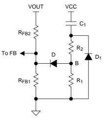
Figure 11. Soft-Start Circuit
