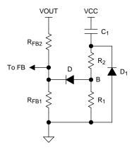
Figure 11. Soft-Start Circuit
