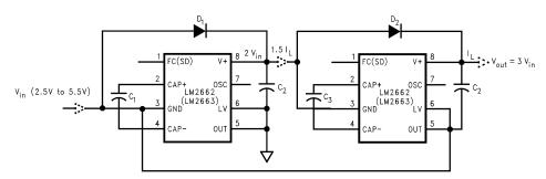
Figure 21. Generating +3 V<sub>IN</sub> From +V<sub>IN</sub>
