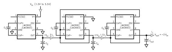
Figure 20. Generating −3 V<sub>IN</sub> From +V<sub>IN</sub>
