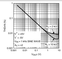
Figure 21. THD+N vs  $V_{\rm OUT}$
