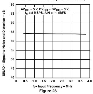
SIGNAL-TO-NOISE vs INPUT FREQUENCY (SINGLE-ENDED)
