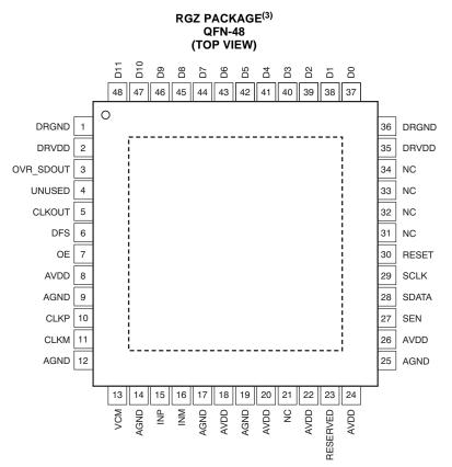
**PIN CONFIGURATION (CMOS MODE)**
