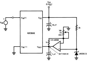
Figure 17. Span Adjust ( $0V \le V_{IN} \le 3V$ )
